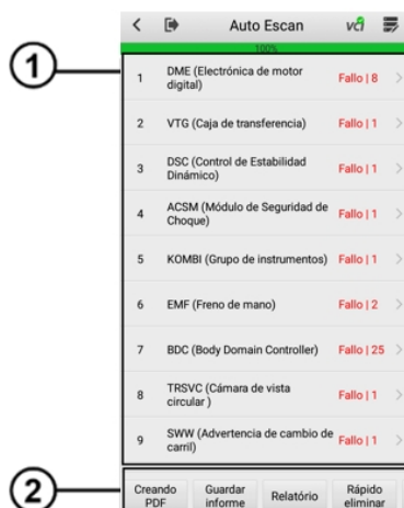
Figura 7-9 Pantalla de operación de escaneo automático
